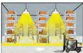
Avec une lumière ambiante insuffisante, le capteur allume la lumière lorsqu'un mouvement est détecté.
