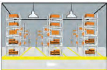
Une fois la période de veille écoulée, le capteur éteint la lumière si aucun mouvement n'est détecté dans la zone de détection.
